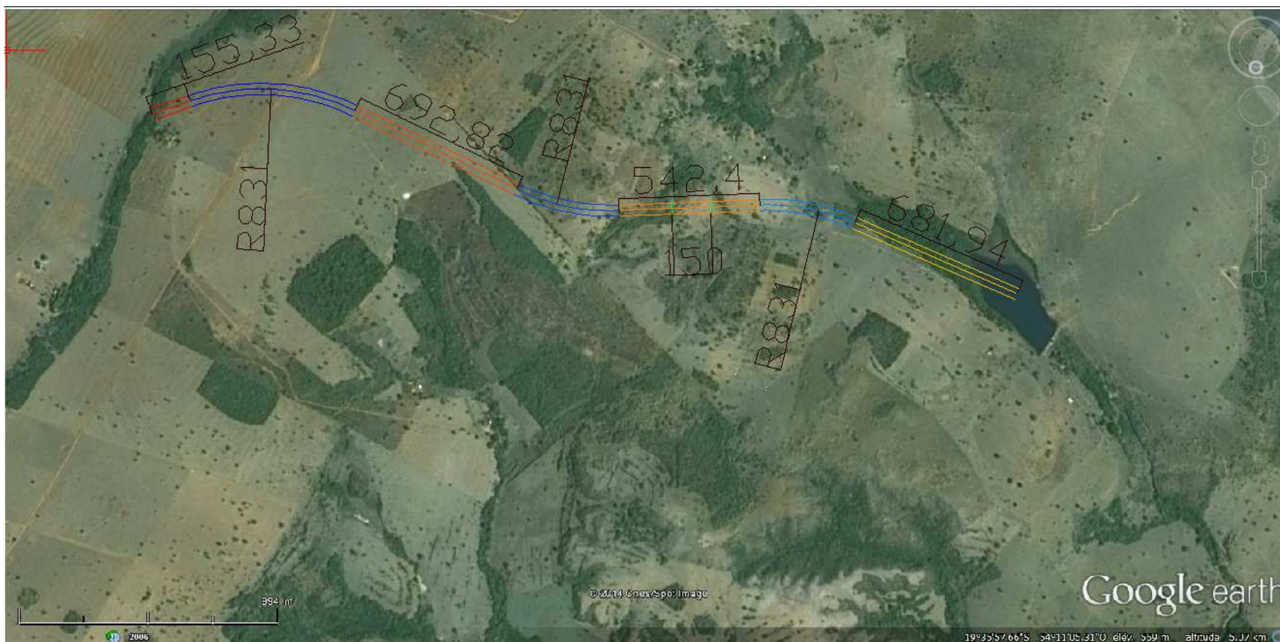
Figura 15: Traçado da alternativa 1 da interligação Taquari-Prado no AutoCAD com um mapa Google Earth
