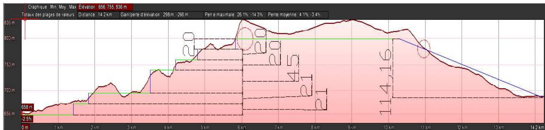
Figura 45: Perfil longitudinal da alternativa é da interligação Araguaia-Paraguai. Os círculos vermelhos marcam os cruzamentos
