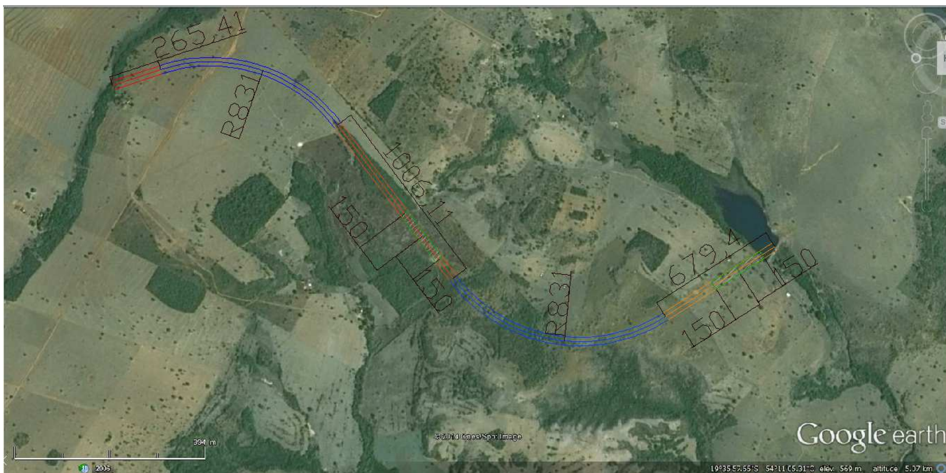
Figura 18: Traçado da alternativa 2 da interligação Taquari-Prado no AutoCAD com uma mapa Google Earth e inserção no Google Earth
