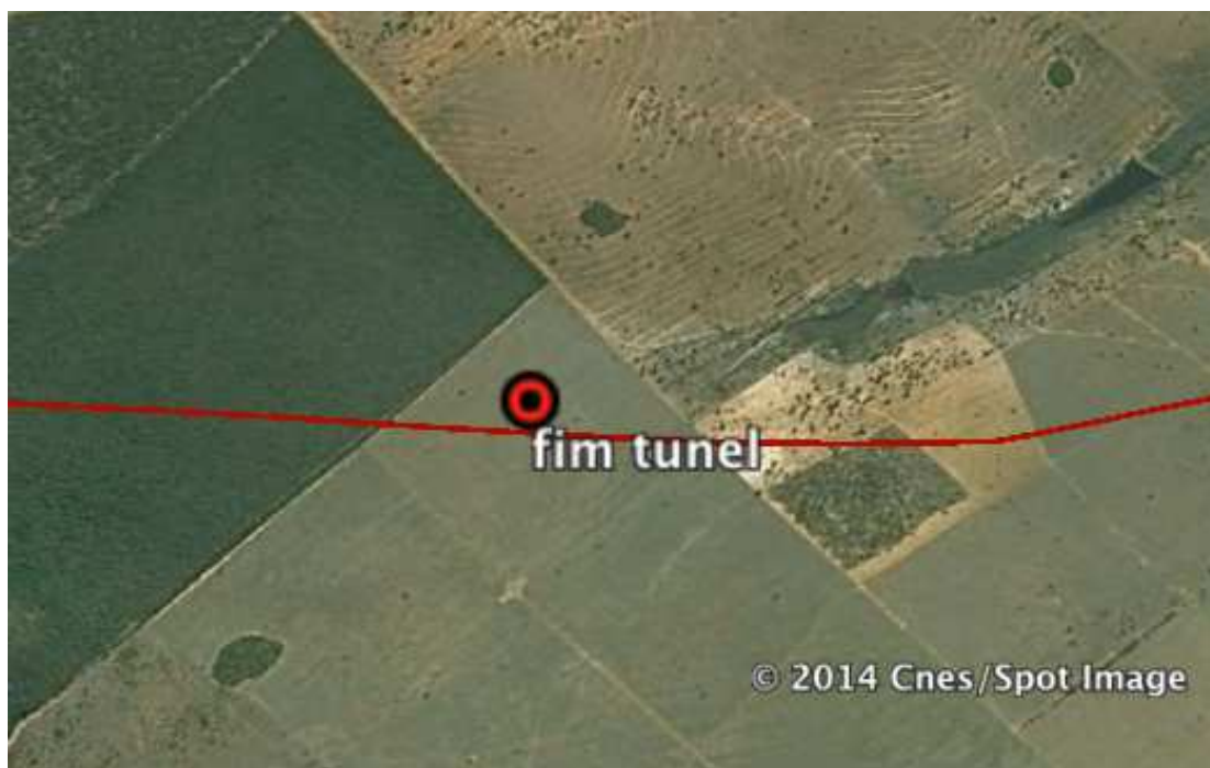
Figura 49: Estradas vicinais de terra na proximidade do fim do túnel serão desviadas permitindo um ponto de passagem a mais
